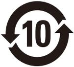
该电子电气产品含有某些有害物质，在环保使用期限内可以放心使用，超过环保使用期限之后则应该进入回收循环系统。
